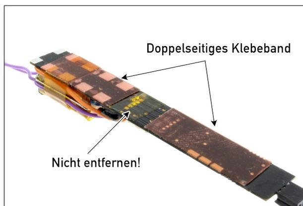
Klebereste der alten Platine vollständig aus der Lok entfernen.
