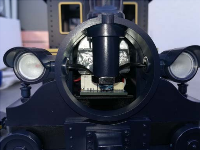
Abbildung 10: LS Decoder zwischen Gewicht und Getriebe
